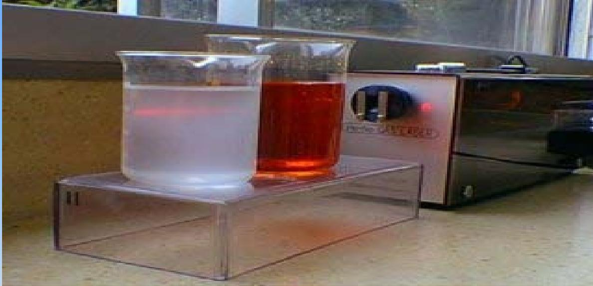
$\text{SiO}_2 \cdot n\text{H}_2\text{O}$  (左侧烧杯)和  $\text{Fe}(\text{OH})_3$ (右侧烧杯) 溶胶
